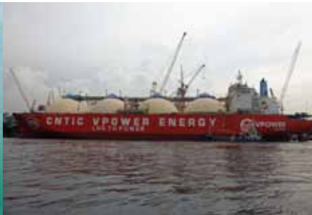
CNTIC Vpower Energy , LNG Floating Storage Unit (FSU) conversion
